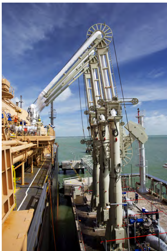
Figure 3.24 Typical LNG Loading Arms
