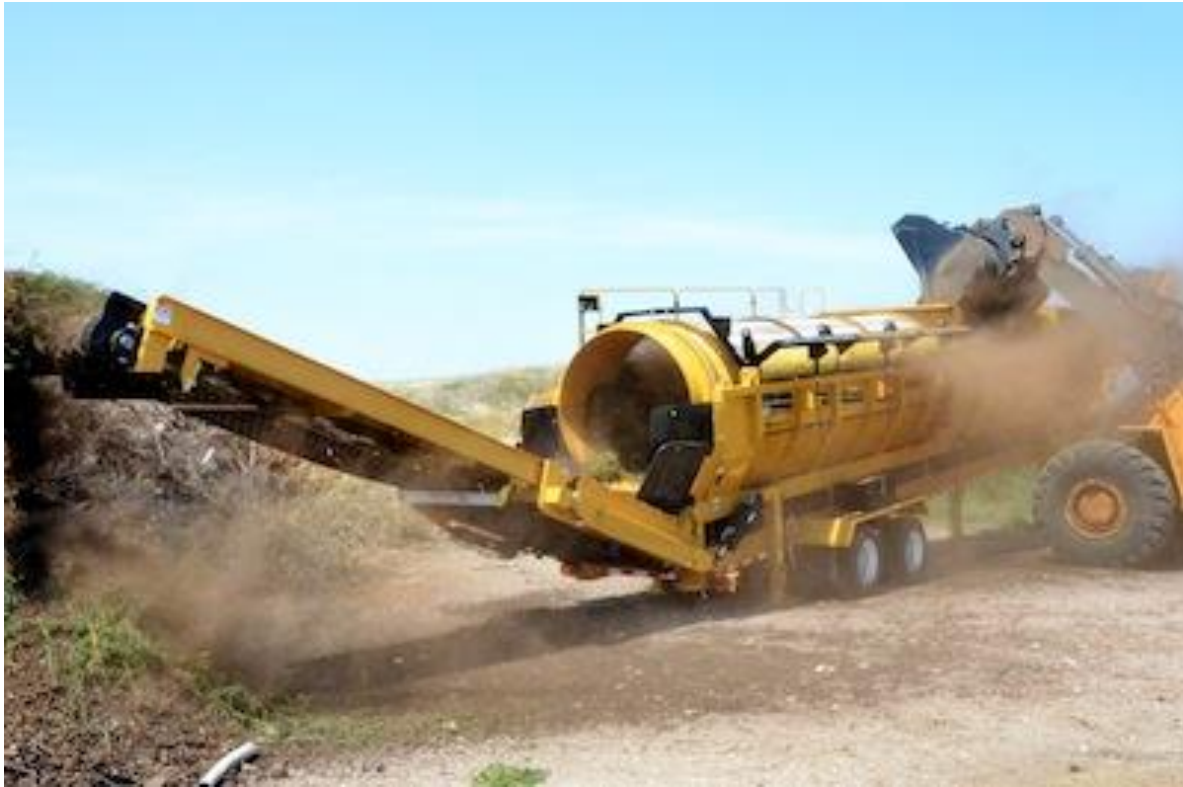
Figure 5 - Vermeer Trommel Screen
