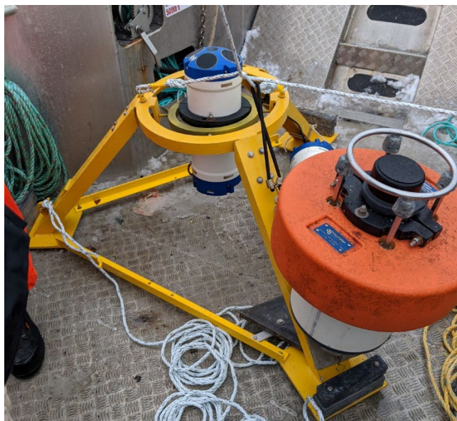
Figure 2.2 : Système pour le déploiement de l'ADCP.
