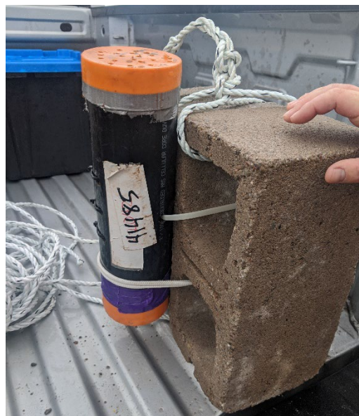
Figure 2.3 : Système pour la fixation du manomètre RBR.
