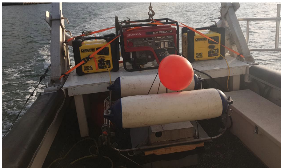
Figure 3.1.4 – Système de boumeur sur le pont après sa récupération.
