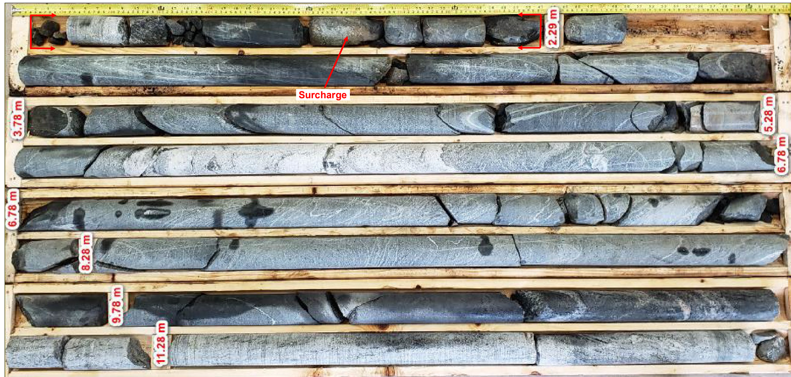
Photographie 3 : Forage BH2 , de 0,61 m à 12,40 m. Foré le 14 juillet 2020.
