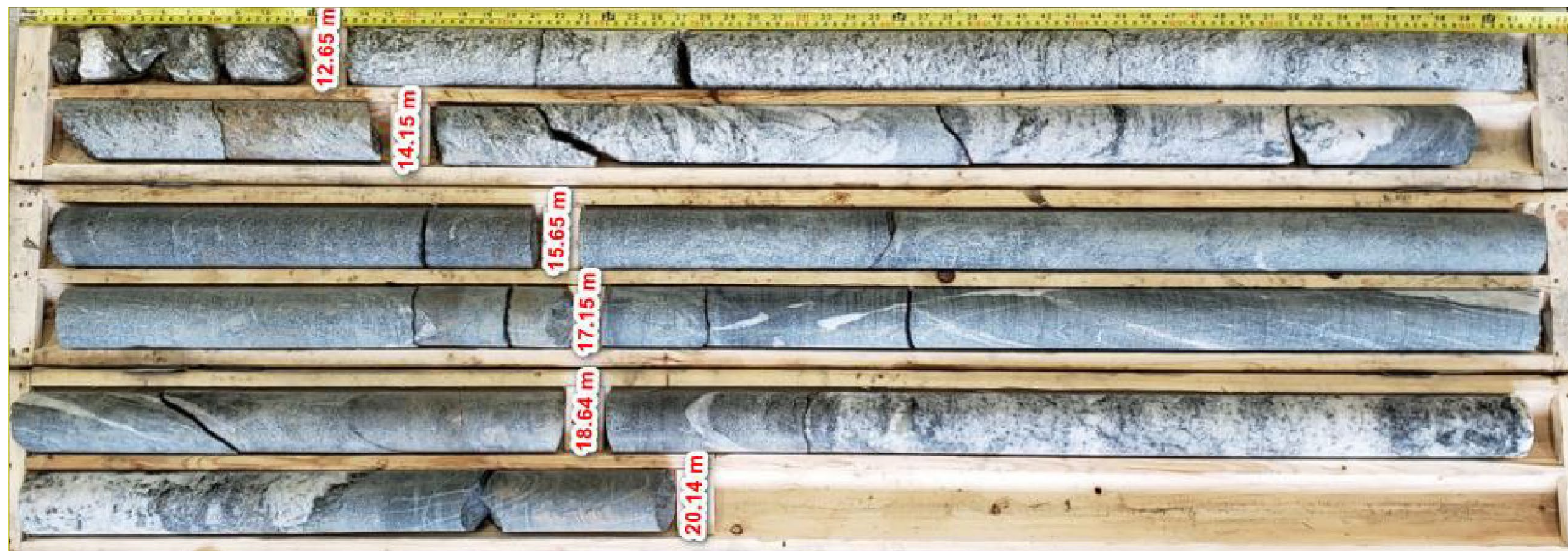
Photographie 2 : Forage BH1 , de 12,65 m à 20,14 m. Foré entre le 13 et le 14 juillet 2020.
