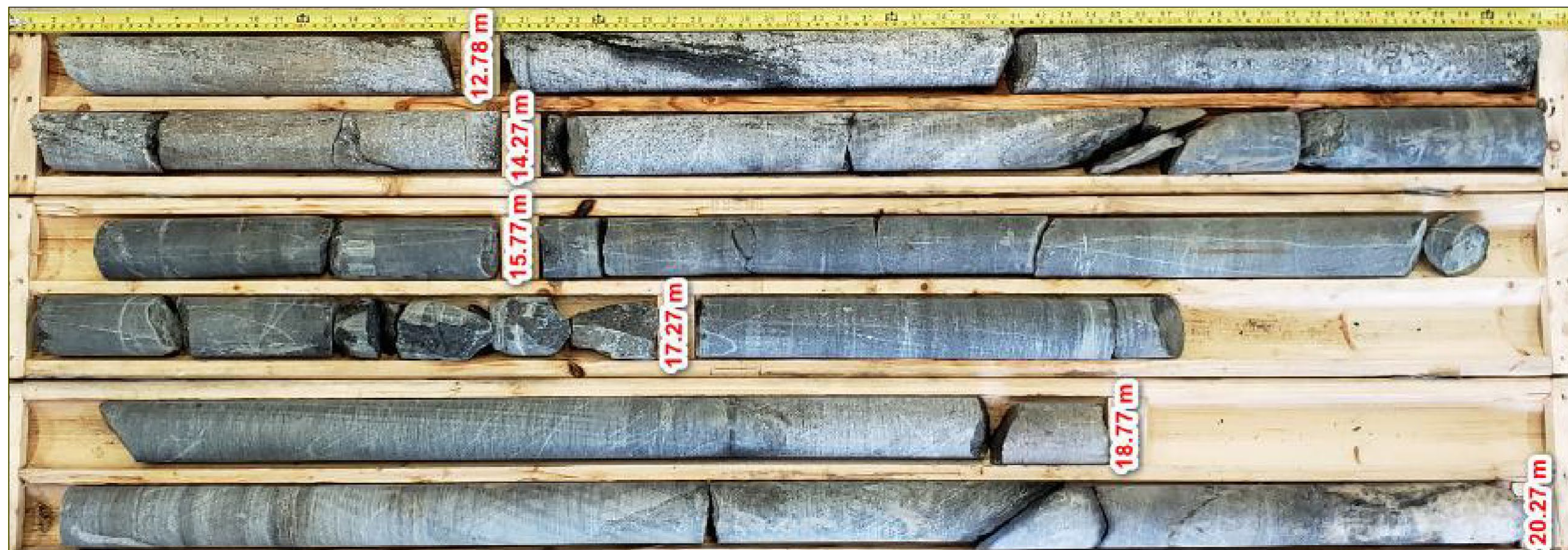
Photographie 4 : Forage BH2 , de 12,40 m à 20,27 m. Foré le 14 juillet 2020.
