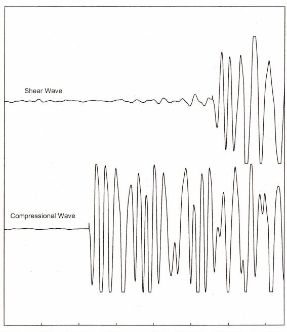
0.000015 0.000025 0.000035 0.000045 0.000055 0.000065 0.000075 0.000085 COMPRESSIONAL AND SHEAR WAVE TRANSIT TIME, seconds
